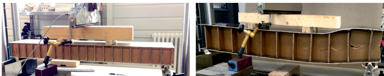
Bild 2. Bestimmung der Schubfestigkeit im 4-Punkt-Biegeversuch (links) und des Schubversagens des Kerns (rechts) (© TU Chemnitz)
